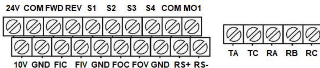
Момент затяжки винтов на клеммах - 0.2 Нм.
