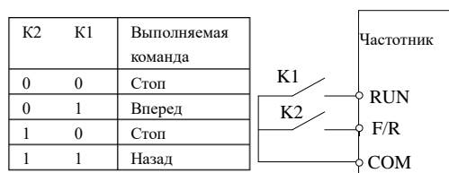
Рис. 6-14 Двухпроводной режим управления 2
