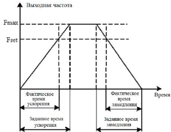
Рис. 6-2 Схема времени ускорения/замедления
