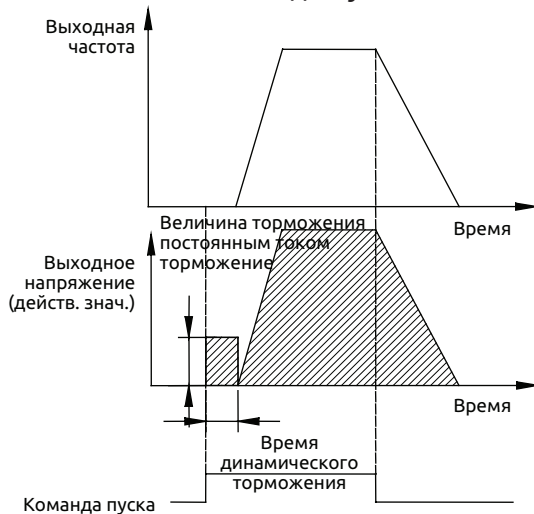
Рис. 7-4 Описание режима пуска 1, заданного кодом F02.06
