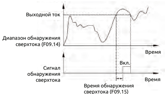
Рис. 7-27 Схема обнаружения сверхтока на выходе
