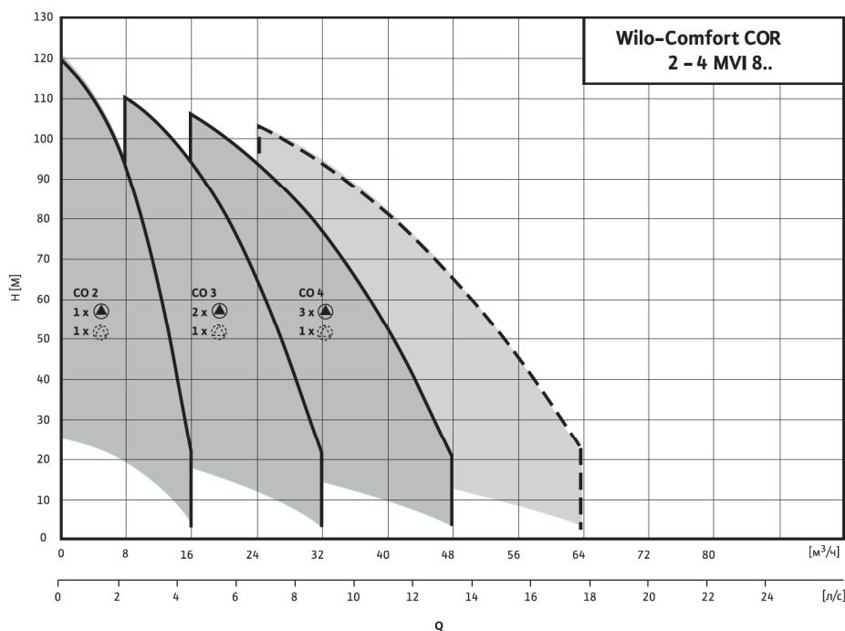
— — — 4-насосов в работе (3 насоса с подключением резервного насоса при пиковых нагрузках)
