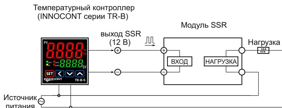
В случае выбора режимов фазового и циклического регулирования **необходимо использовать один источник питания для нагрузки и температурного контроллера.**
