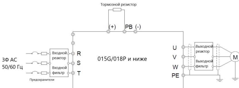
Рис. 4-7 Схема подключения силовых цепей для моделей 015G/028P и ниже
