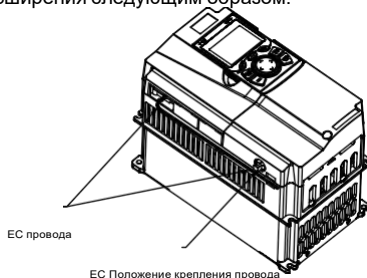
Рис А.5 Прокладка проводов для платы расширения
