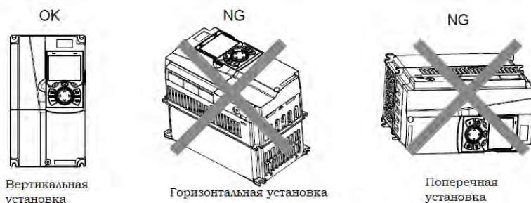
Рис 4.1 Ориентация ПЧ при установке
