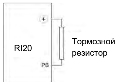
Рис. 12-3. Схема подключения тормозного резистора
