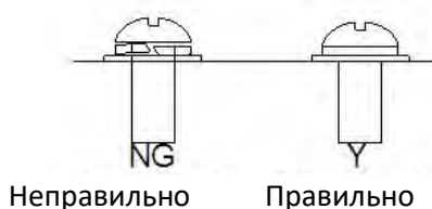
Рис. 5-14 Правильная установка винтов
