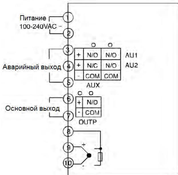
Примечание: Схема для вертикальных контроллеров типоразмеров А и Е.
