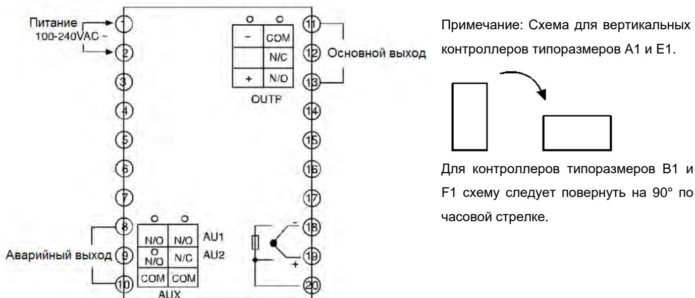
**Схема подключения для контроллеров типоразмера D (72 x 72 мм):**
