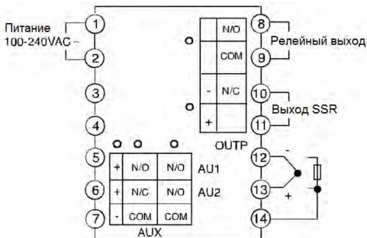
**Схема подключения для контроллеров типоразмеров D1/D2 (48 x 48 мм):**
