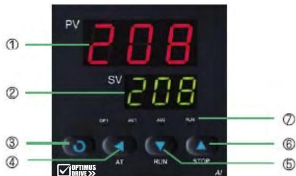
При включении отображается основное состояние дисплея (базовый экран), в верхнем окне отображается текущее значение (PV), а в нижнем окне отображается заданное значение (SV). Если текущее значение выходит за пределы диапазона измерения (например, неисправность термопары), в верхнем окне будет отображаться «огА» и самое высокое и самое низкое значения, при этом контроллер автоматически прекратит управление выходом.
