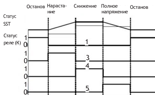
Статус выхода нескольких реле
