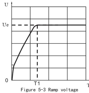
Рис. 5-3 Линейно изменяющееся напряжение
