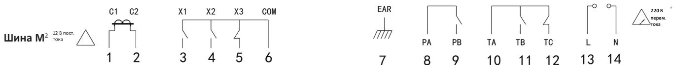
Рис. 3-4 Расположение клемм управления устройства плавного пуска MCD5
