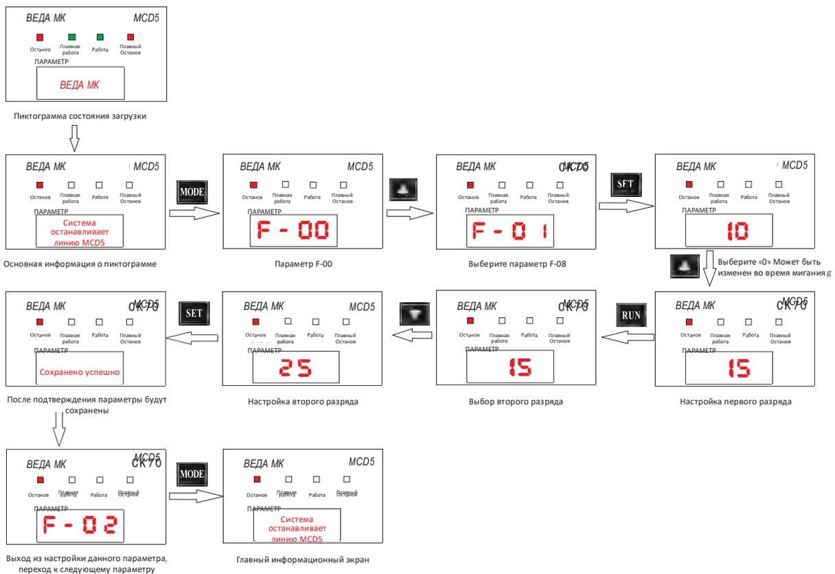
Рис. 4-4 Схема экрана
