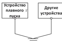
Рис. 3-8b Схема заземления 2
