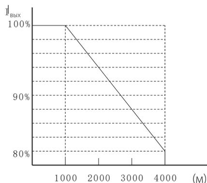
Рис. 1-2 Зависимость между номинальным током устройства плавного пуска и высотой над уровнем моря
