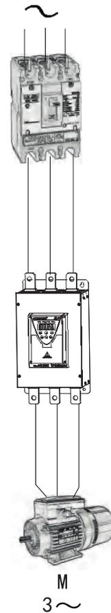
Рис. 3-2b Схема подключения силовой цепи УПП MCD5
