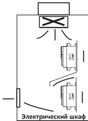
Направление вентиляции показано на рис. 3-1d:
