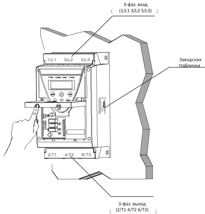
Рис. 3-7 Общая структура устройства плавного пуска серии MCD5
