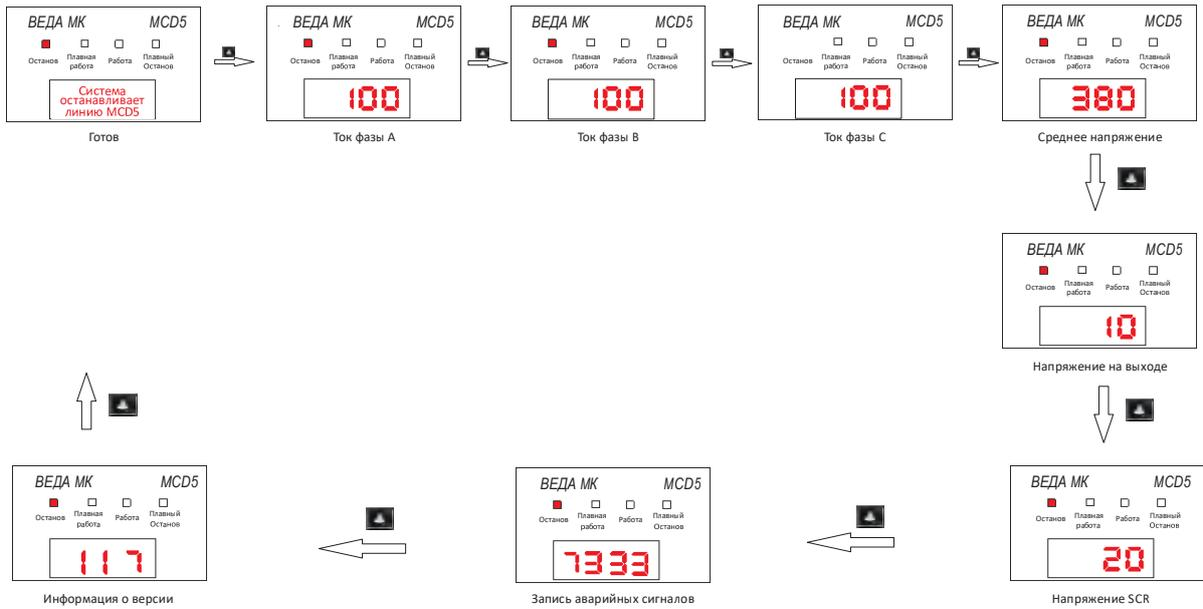
На рис. 4-2 показан процесс пролистывания содержимого экрана
