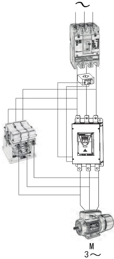
Рис. 3-2a Схема подключения силовой цепи УПП без байпасного контактора.
